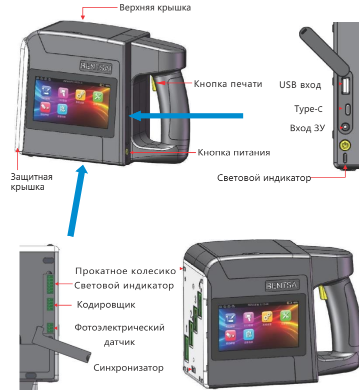
Схема компонентов ручного струйного принтера
